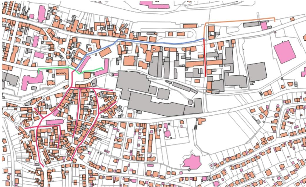
Abbildung 67: Potenzielle Wärmenetze im denkmal-Gebiet mit Energiezentrale bei den Stadtwerken Lambrecht
