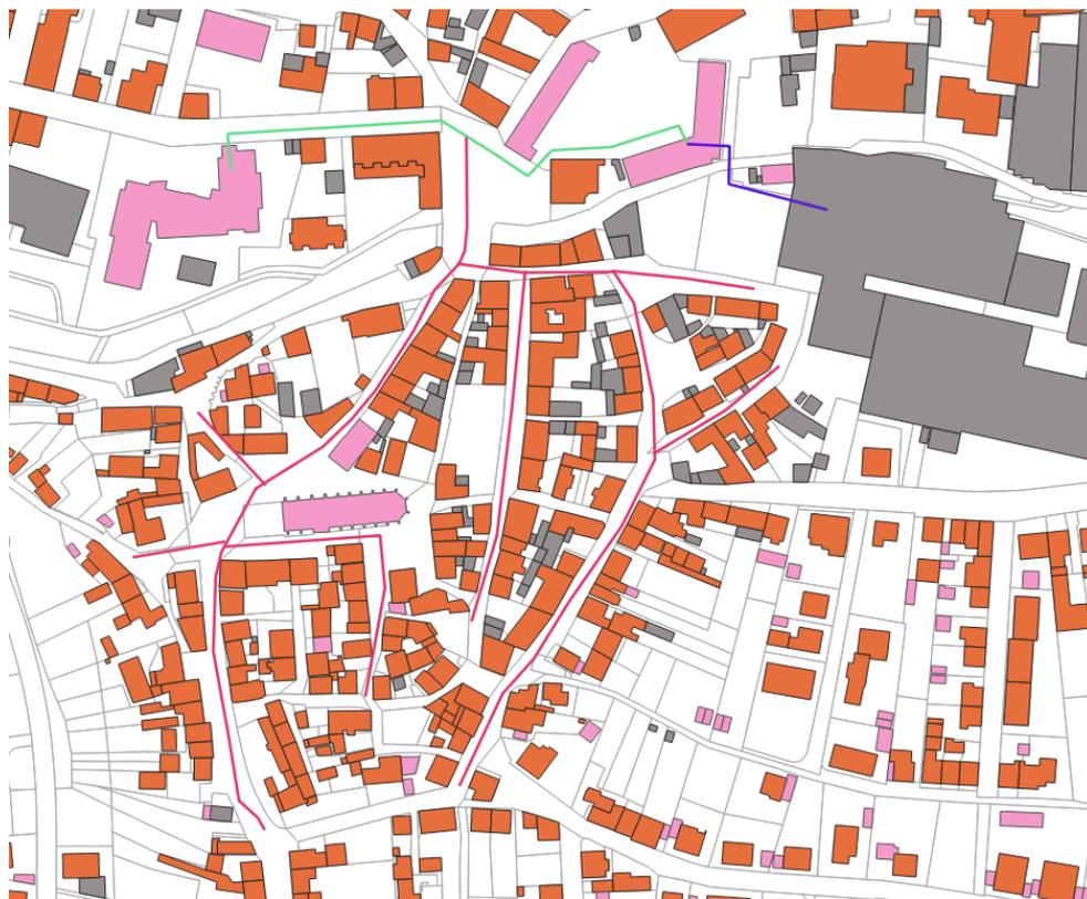
Abbildung 66: Potenzielle Wärmenetze im denkmal-Gebiet mit Energiezentrale bei J.J. Marx
